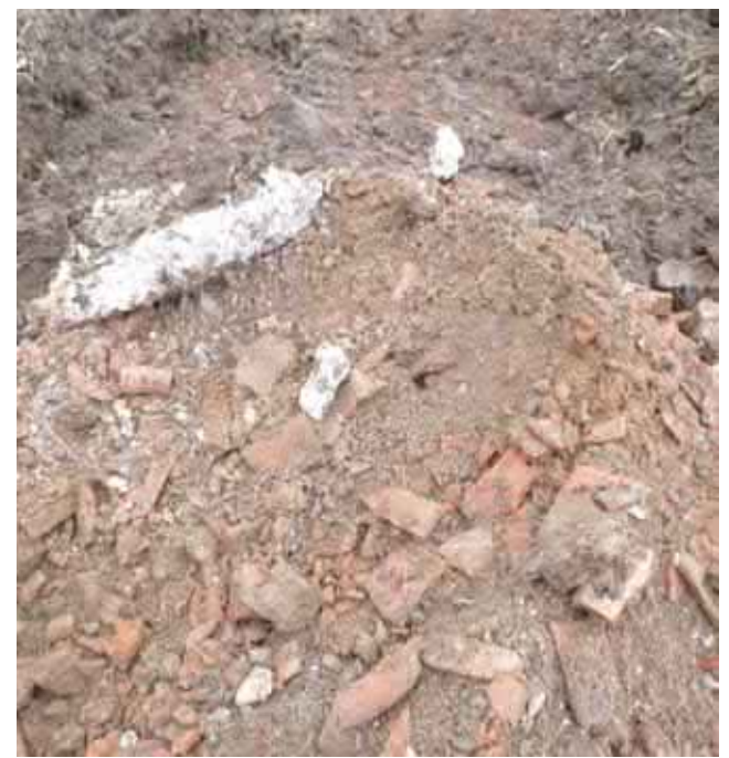
Foto 4: Schurf R16 Fläche Typ3 – Bauschutt flächig unter Oberboden (Foto: Buck, 27.01.2022)
