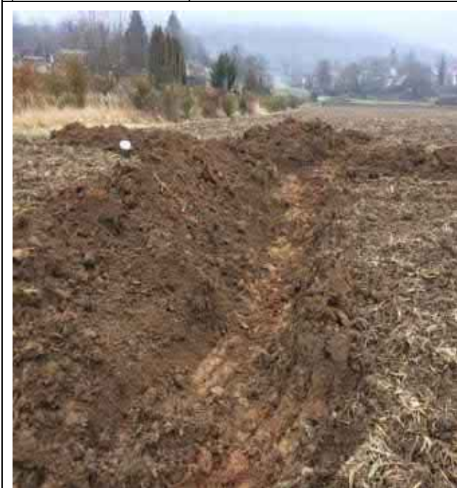
Foto 3: Schurf R14 Fläche Typ 2, lokal Bauschutt unter Oberboden (Foto: Binninger, 26.01.2022)
