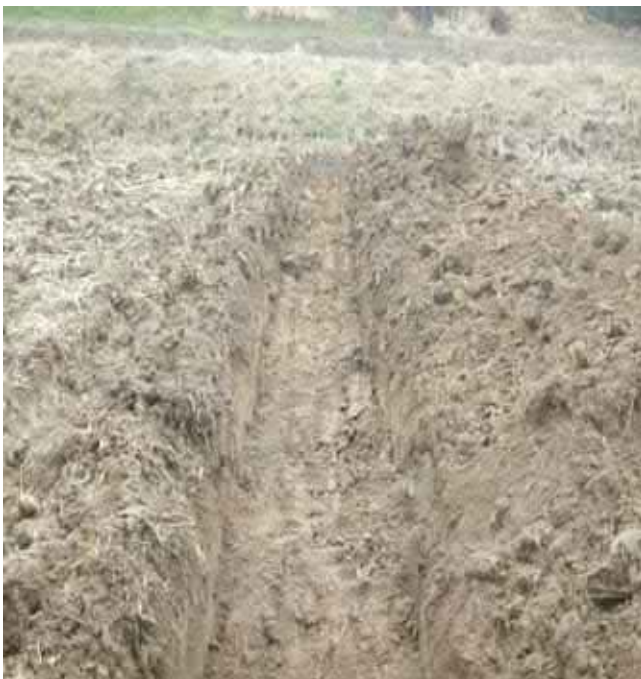
Foto 3: Schurf R12 Schurf R11 Mutterboden über anstehender Decklage Fläche Typ1 – keine Auffüllung festgestellt (Foto: Buck, 26.01.2022)
