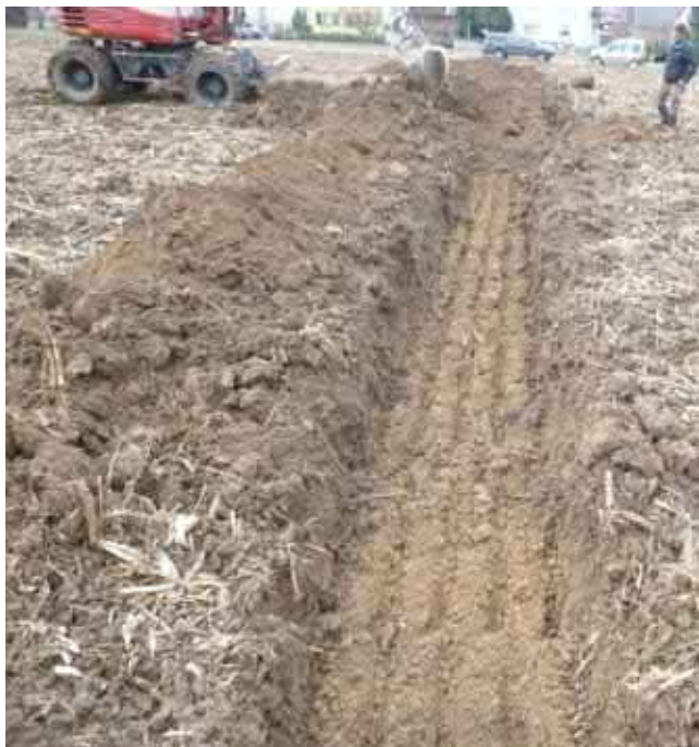
Foto 3: Schurf R16 Fläche Typ2 - lokal Bauschutt unter Oberboden (Foto: Buck, 27.01.2022)
