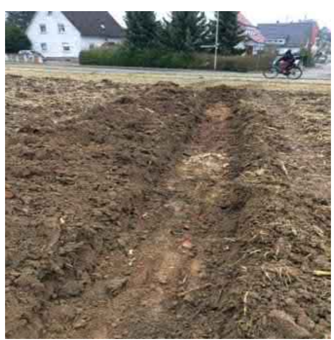
Foto 2: Schurf R15 Fläche Typ3 – Bauschutt flächig unter Oberboden (Foto: Binnerer, 26.01.2022)
