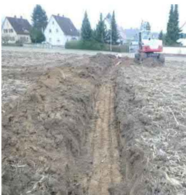
Foto 1: Schurf R15 Fläche Typ2 - lokal Bauschutt unter Oberboden (Foto: Buck, 26.01.2022)
