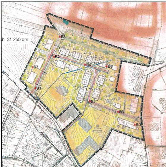
Abbildung 5: Lage der Baggerschürfe; Quelle: Geo- technischer Bericht, Hydrosond, 13.01.2020
